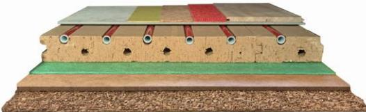
Auch unsere Zementfaserplatte (Baubiologisch geprüft) kann zur Verlegung auf Lethermo verwendet werden. Zum Ausgleich von Unebenheiten wird eine Wellpappe eingelegt (Achtung: Kontrolle ob Wärmeleistung ausreichend!) Oder es wird die Fläche mittels Lehmkleber und Gewebe zu eine planen Oberfläche abspachtelt.
