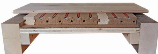
Im Fehlbodenbereich können die Platten auch zwischen den Balken „abgesenkt“ verarbeitet werden. Meist wird man dann gut um die Rohrstärke nach oben überstehen lassen (falls von der Statik her ausreichend, könnten die Rohre auch in die Balken geschlitzt werden.
