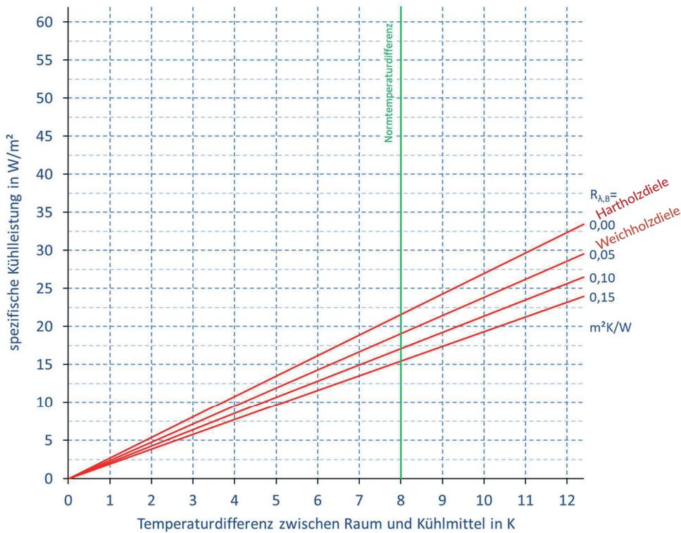
Lethermo Fußbodenheizsystem mit **Verlegeabstand 140 mm**
